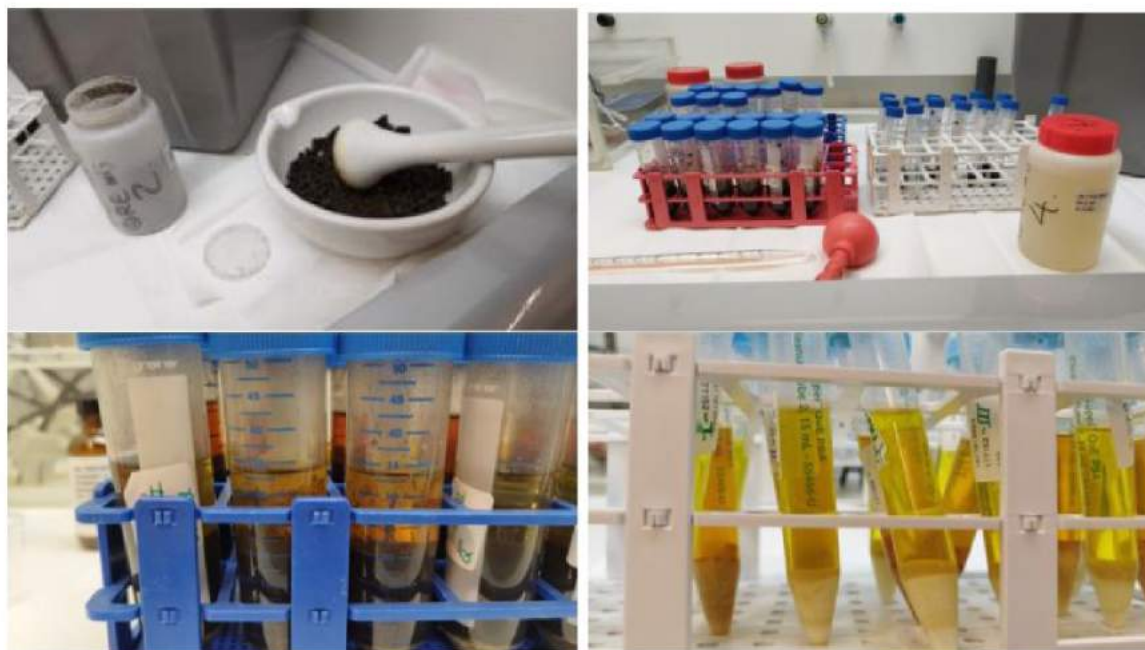
Figuur 1: Foto's van de monstervoorbewerking en extractieprocedure (linksboven: pellets / rechtsboven: monsters in centrifuge tubes / linksonder: extractieprocedure met acetonitril / rechtsonder: clean up procedure).
